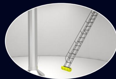
> Les bassins Tunor peuvent être équipés d'échelles amovibles dotées d'un flotteur en extrémité afin de ne pas constituer d'obstacle durant le fonctionnement normal mais d'être toujours disponible lorsque le bassin est vide.
